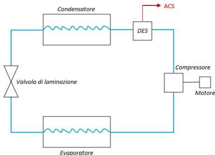
Il gruppo frigorifero a recupero totale, nel senso proprio del termine, recupera completamente il calore rilasciato dal fluido refrigerante durante il desurriscaldamento e la conseguente condensazione. Ciò è possibile attraverso un sistema di regolazione automatica con valvola a 3 vie, con la seconda via verso il condensatore e la terza diretta al recuperatore.
