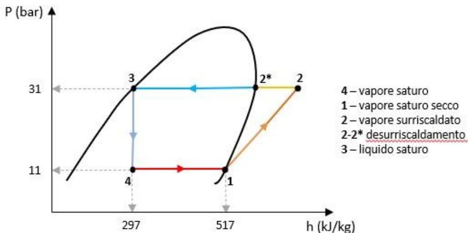
Fissando la pressione a 11 bar, l'R32 evapora alla temperatura di circa  $10^{\circ}\text{C}$ , portando poi la pressione a 31 bar condensa alla temperatura di circa  $50^{\circ}\text{C}$ .
