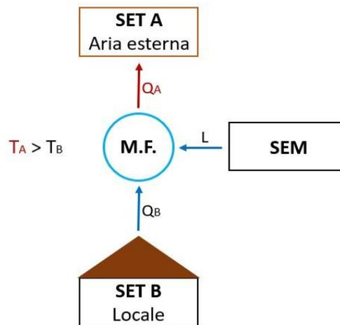
• **Pompa di calore** - il COP rappresenta il rapporto tra l'energia termica da fornire al SET a temperatura superiore e l'energia meccanica spesa:
