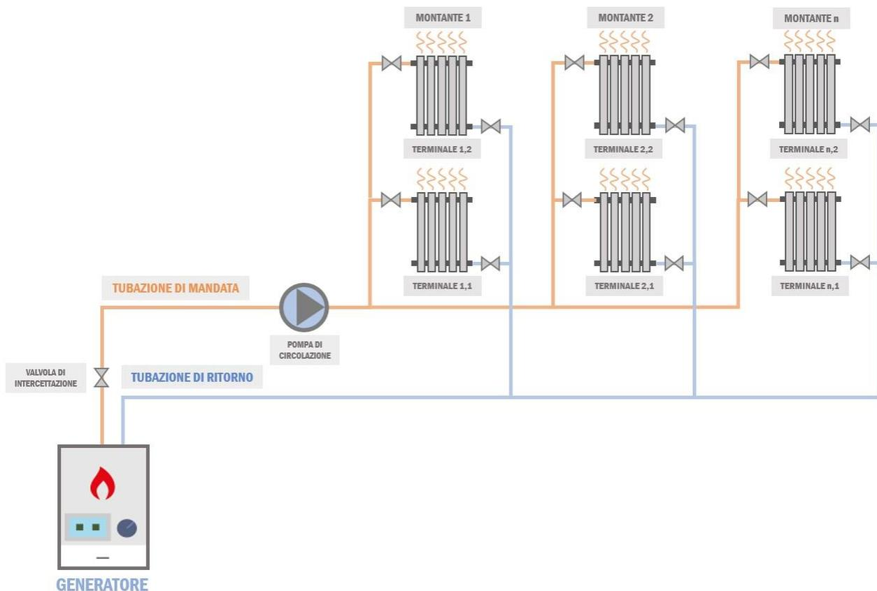
Questa soluzione<sup>(1)</sup> è impiegata particolarmente per impianti centralizzati, in cui il generatore è posto al piano terra o seminterrato, così come l'annessa rete principale di tubazioni di mandata e di ritorno. Da questa si ergono poi delle montanti verticali che sezionano verticalmente l'edificio ed alimentano i corpi scaldanti dei vari piani (appartamenti).
