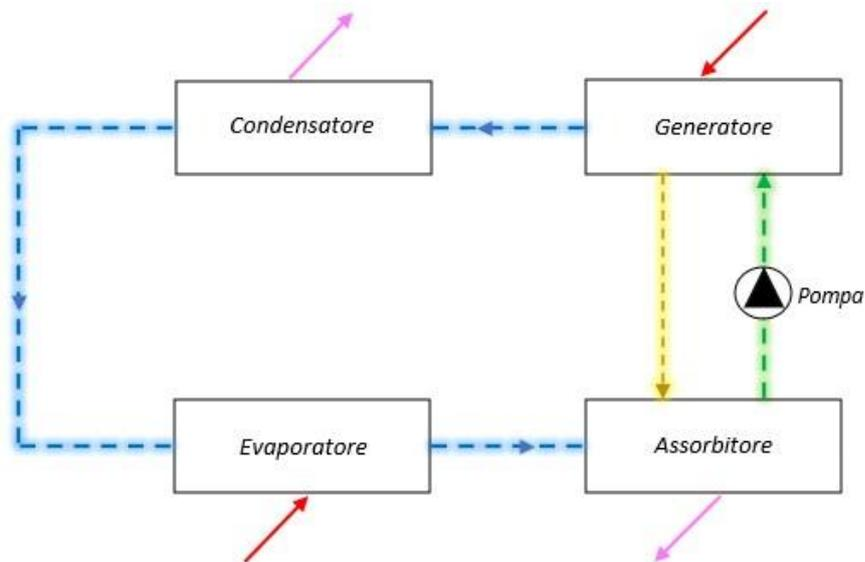
Talvolta, possono essere costituite anche da due generatori, il primo generatore lavorerà a pressione e temperatura maggiori rispetto al secondo. In questo caso si parla di macchina bistadio, quando la miscela viene riscaldata, non tutto il refrigerante riesce ad evaporare nel generatore, quindi, con il primo generatore evaporerà una parte di refrigerante, con il secondo evaporerà invece la restante. In tal modo migliora la prestazione globale della macchina.
